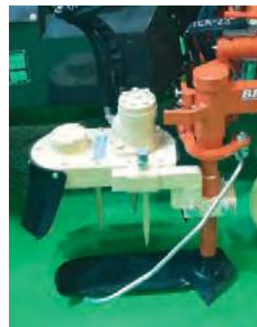
L'axe vertical pivote et permet de s'effacer devant les pieds.
